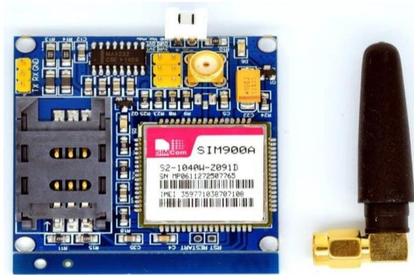
Fig. 2. SIM module (SIM900).
